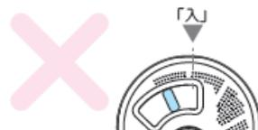
※ウルトラファインバブル切替レバーは途中で止めず、必ずレバーが止まる位置まで動かしてください。
